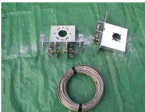
ロ - テーター台・ベアリング台(2軸滑車付き) ワイヤー (6mm)
